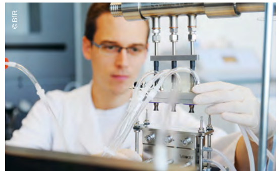
Versuchsaufbau: Drei Röhrchen leiten ein Testaerosol mit luftgetragenen Nanomaterialien auf Epithelzellen.
