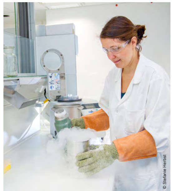
Die Vorbereitung der Käseproben für die Untersuchung beinhaltet die Homogenisierung mit flüssigem Stickstoff.
