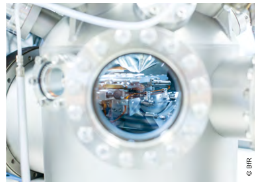
Per Flugzeitmassenspektrometer lässt sich Silber auf beschichteten Textilfasern detektieren.
