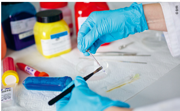
Zur thermischen Behandlung mittels Pyrolyse werden Farbpigmente in Untersuchungsröhrchen gefüllt.
